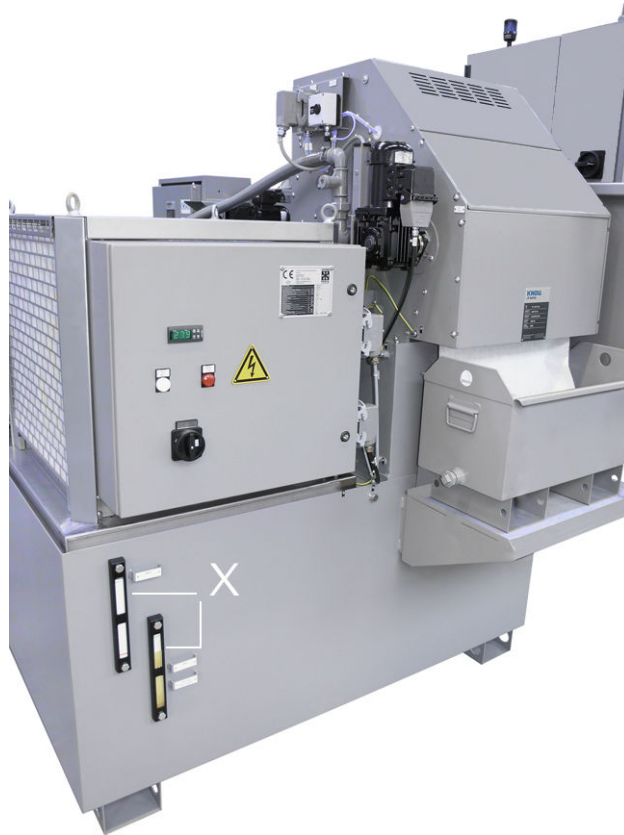
Füllstandsanzeige an einer Kühlschmierstoff-Aufbereitungsanlage (Fa. Knoll)
